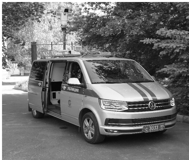
Фото 1. СПК с поднятой телескопической системой освещения с комплексом фото- и видеофиксации
