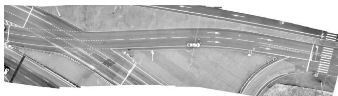
Фото 4. Результат раскадровки видеозаписи с БВС (выполнена с высоты около 50 м с целью обзора максимально возможного по протяженности участка) с использованием ПО «Adobe Photoshop»: зафиксировано взаимное расположение проезжих частей, имеющих криволинейную конфигурацию
