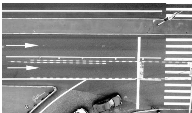
Фото 3. Пример использования БВС при дополнительном осмотре места происшествия для определения размерных характеристик и взаимного расположения средств организации дорожного движения
