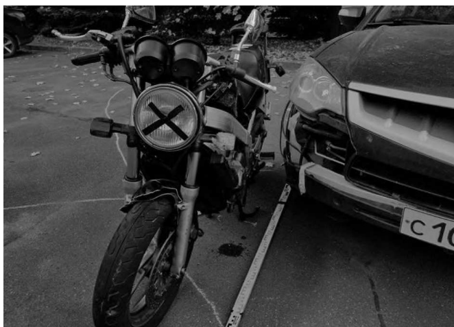
Фото 8. Сопоставление повреждений мотоцикла и автомобиля, зафиксированное 3D-сканером «FARO Focus 3DX 330» в режиме фотосъемки
