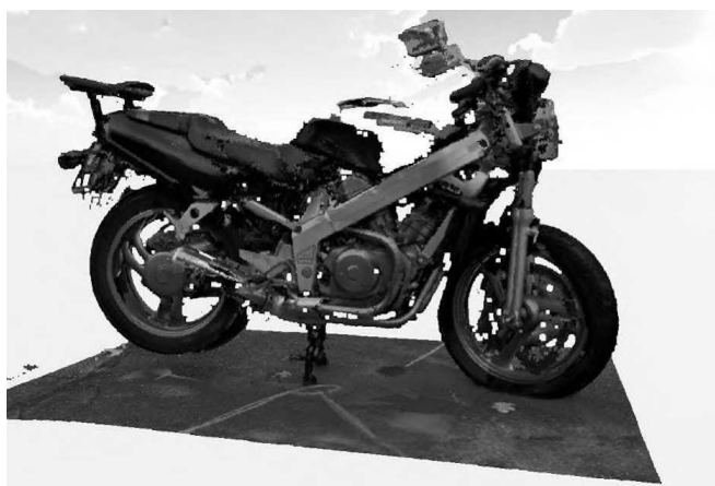
Рис. 4. Изображение мотоцикла, полученное при помощи 3D-сканера «FARO Focus 3DX 330» в режиме сканирования с получением трехмерного «облака точек»
