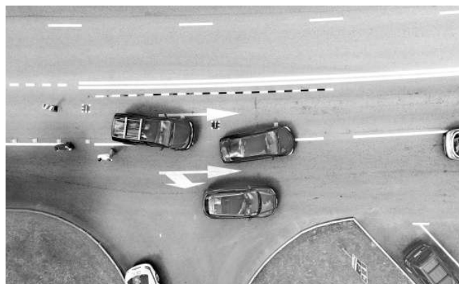
Фото 2. Пример фиксации обстановки места происшествия с использованием БВС с применением мерных объектов — глубинных масштабов и квадратов
