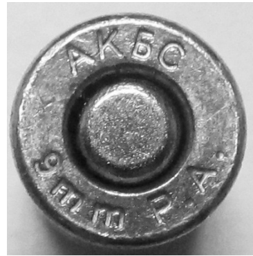
Фото 5. Заводская маркировка травматического патрона
