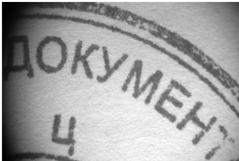
Рис. 3. Увеличенное изображение фрагмента оттиска, нанесенного печатью, изготовленной по «Flash»-технологии
