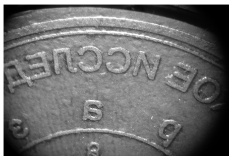
Рис. 2. Изображение оснастки и рабочей поверхности печати, изготовленной по «Flash»-технологии
