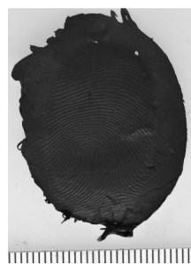
*Фото №4. Силиконовый слепок, изготовленный со вдавленного следа пальца руки на пластилине*
