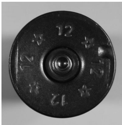
Фото 1. Вид следов от затвора «Мосберг–500», отобразившихся при выстреле на донце отстреленной гильзы 12 калибра
