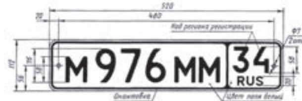
Рис. 3. Регистрационный знак типа 1 с двухзначным кодом региона регистрации (с разметкой размерных параметров).
