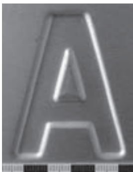
Рис. 7. Отображение буквы «А» с резкими контурами пуансона.
