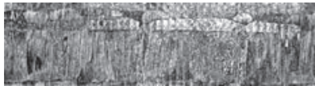
Рис. 7. Ведущая часть пули патрона 9x18 мм, выстреленной из 9 мм пистолета Чешска Збройовка (CZ-83).
