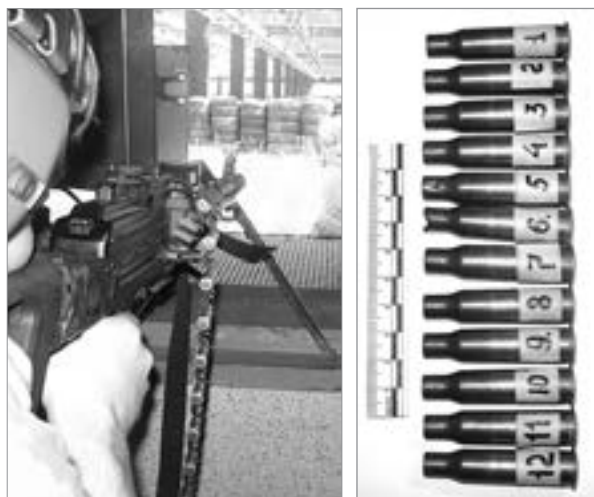
Рис. 1. Стрельба из пулемета одиночными выстрелами при снаряжении ленты патронами через одно звено: а – стрельба из пулемета 6П41 одиночными выстрелами; б – нумерация гильз.
