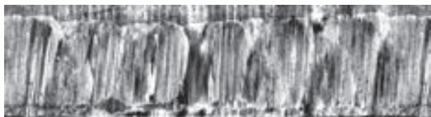
Рис. 5. Ведущая часть пули патрона 9x19 мм, выстреленной из 9 мм пистолета Джерихо 94F.
