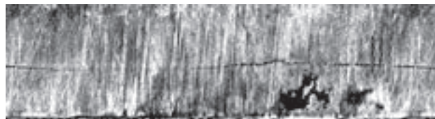
Рис. 6. Ведущая часть пули патрона 9x19 мм, выстреленной из другого экземпляра 9 мм пистолета Джерихо 94F.
