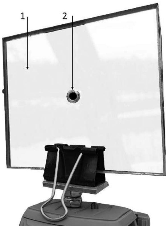
Фото 4. Зеркало с отверстием для визирования с использованием нити по двум пробоинам: 1 — зеркало, 2 — отверстие
