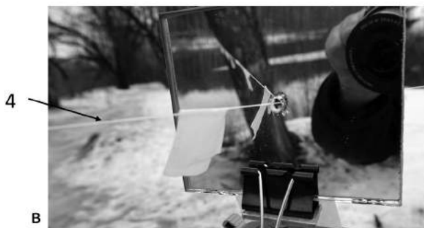
Фото 5. Визирование с использованием нити и зеркала по двум пробоинам: а — касательная пробоина на одном из деревьев; б — общая схема визирования; в — фотографирование результатов визирования: 1 — касательный след пули; 2 и 4 — нить; 3 — слепая пробоина во втором дереве
