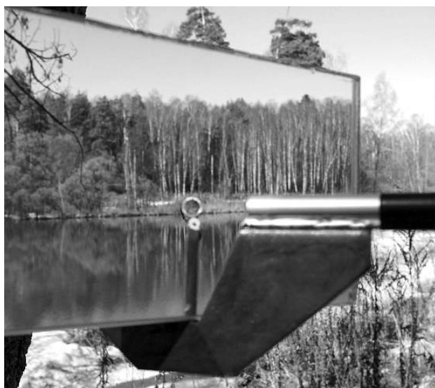
Фото 2. Установка приспособления для визирования линии полета пули: 1 — фотоаппарат на штативе; 2 — пластина; 3 — отверстие для проверки соосности спиц
