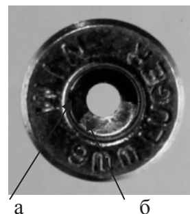
Рис. 5. Гильза пистолетного патрона 9x19 мм Р-08 с устройством капсюльного гнезда для капсюлей закрытого типа (Жевело)
