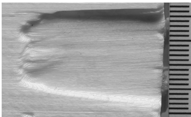
Илл. № 6. Модель следа, выполненная на отечественном принтере системы FDM (подложка перед печатью располагалась под углом)
