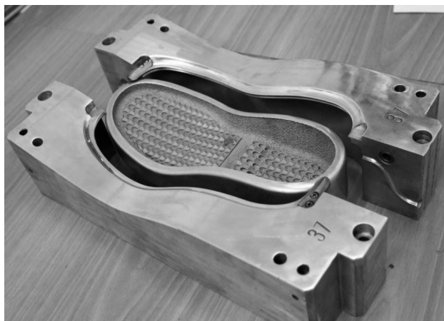
Рис. 2, 3. Металлическая пресс-форма и ее схематическое изображение (1 – металлическая колодка, где устанавливается верх обуви; 2 – полуматрицы; 3 – пуансон)
