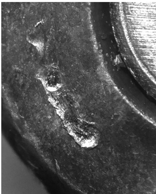
Рис. 3. Следы отражателя на торце донной части гильзы
