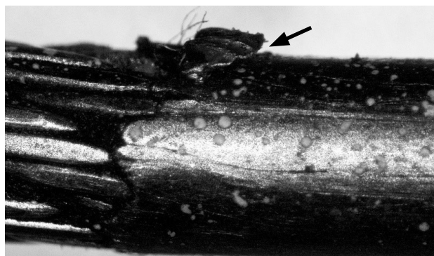
Фото 3. Фрагмент колпачка троса ЗПУ «TP350-01». Стрелкой показан край входного отверстия колпачка, загнутый в сторону отпирания пломбы
