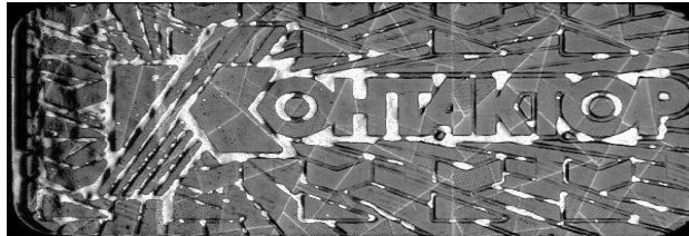
Рис. 6. Увеличенные изображения имитации голографической наклейки на подложке, выполненной способом холодного тиснения
