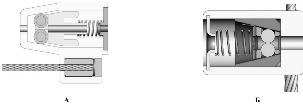
Рис. 2. ЗПУ «ТП350-01» (А) и «Блок-Гарант М» (Б) со схемами запирающих механизмов
