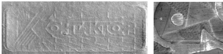
Рис. 7. Увеличенные изображения подложки и фрагмента имитации голографической наклейки с дифракционными элементами, выполненной способом холодного тиснения
