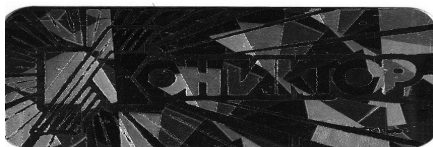
Рис. 6. Увеличенные изображения имитации голографической наклейки на подложке, выполненной способом холодного тиснения
