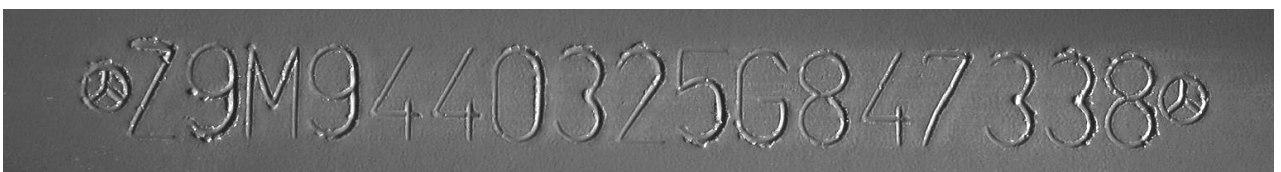
Рис. 4. Идентификационный номер автомобиля после обработки антикоррозионным покрытием
