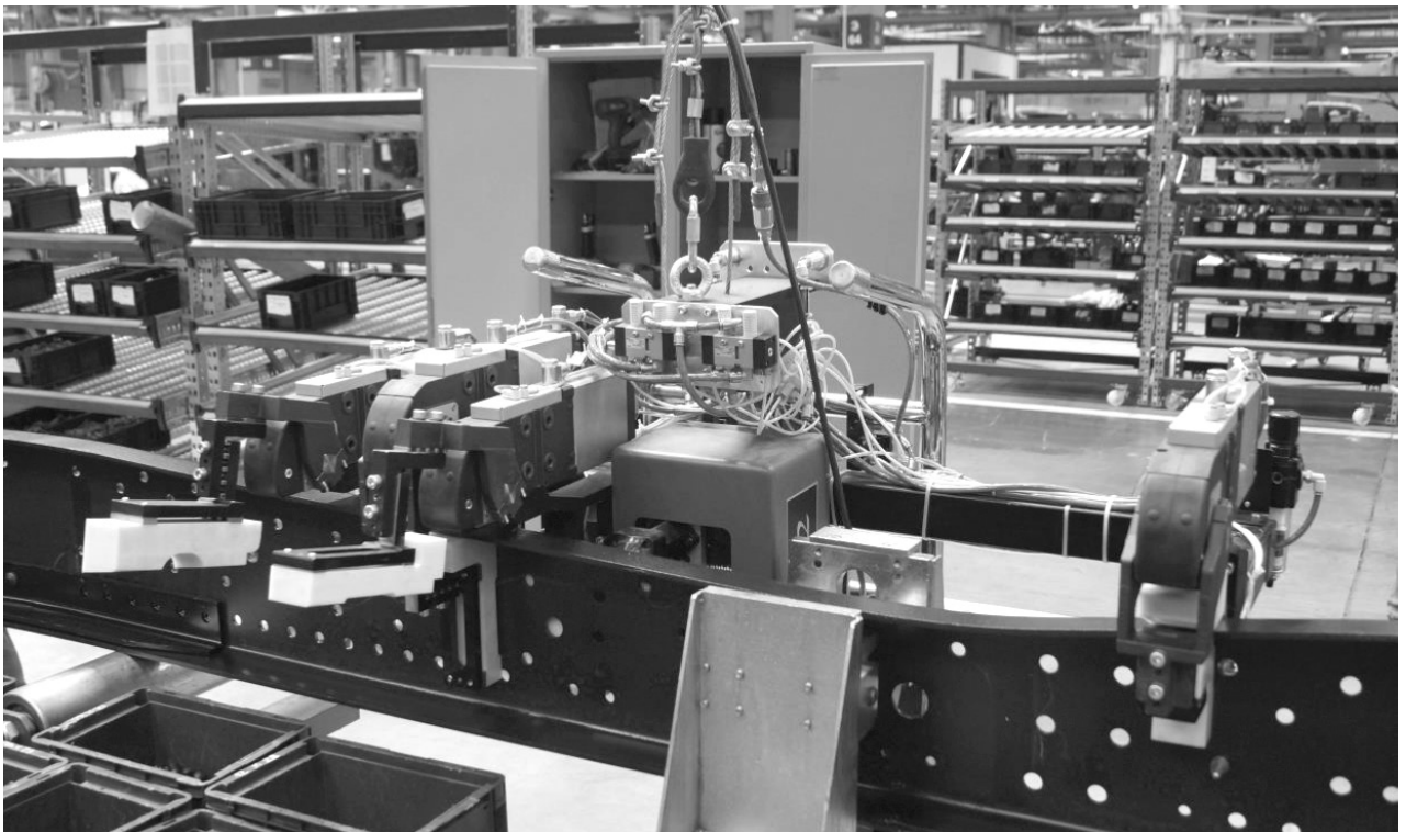
Рис. 2. Рама автомобиля с закрепленным на ней маркатором «TeleScribeSC5000»
