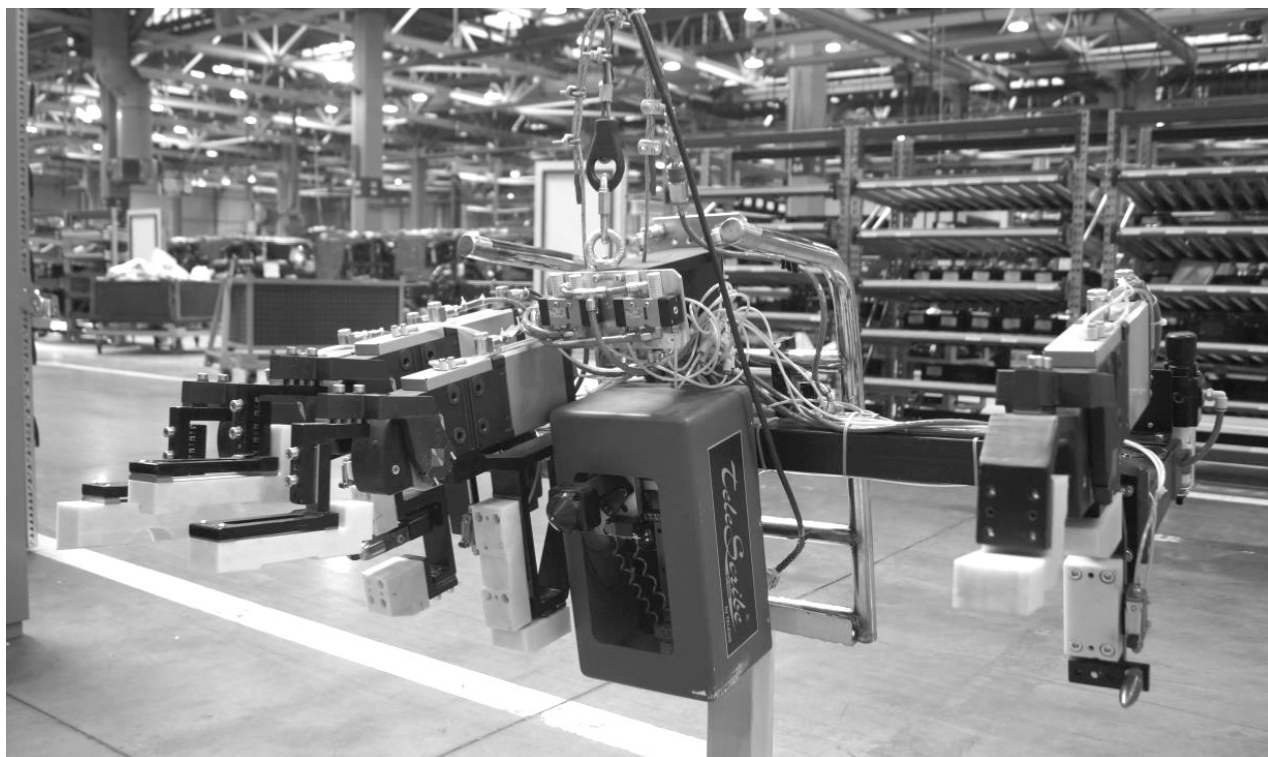
Рис. 1. Автоматизированный маркиратор гравировального типа «TeleScribeSC5000»
