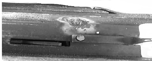
Рис. 12. Наплывы металла на левой стенке затворной коробки пистолета-пулемета системы Г. С. Шпагина
