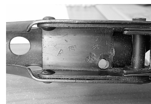
Рис. 6. Увеличенное изображение клейм на внутренней поверхности ствольной коробки
