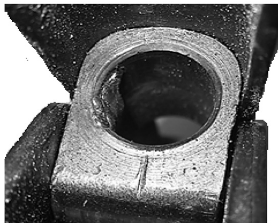
Рис. 11. Наплывы металла на вкладыше крепления ствола ствольной коробки с кожухом ствола пистолета-пулемета системы Г. С. Шпагина
